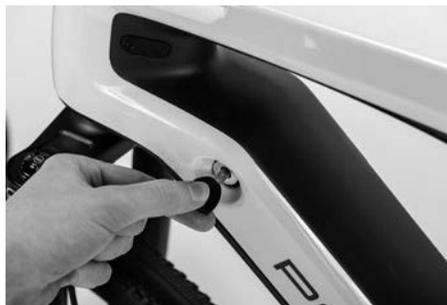
Die Antriebsbatterie löst sich aus dem Antriebsbatterieverschluss im Unterrohr. Eine Zweifach-Verschlussplatte hält die Antriebsbatterie in Position und verhindert ein Herausfallen. Drücken Sie die Zweifach-Verschlussplatte und entnehmen Sie die Antriebsbatterie aus dem eBike.
