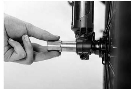
Das Vorderrad des PORSCHE eBike Sport besitzt keine werkzeuglose Achsverschraubung. Es wird ein Torx-Schlüssel (Größe T25) benötigt. Stellen Sie vor der Montage sicher, dass die Gewinde frei von Verschmutzungen und Beschädigungen sind. Schieben Sie die leicht gefettete Steckachse von rechts bis zum Anschlag durch die Ausfallenden und die Nabe.
