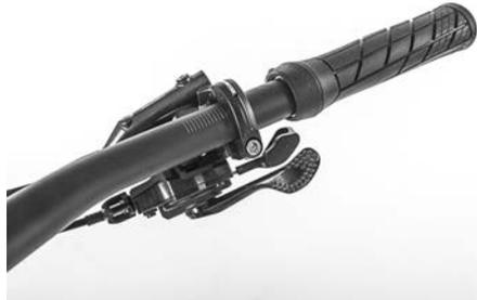
Abb. 24: Position der Schalthebel (elektronisch)
