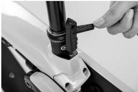
Die Anzugsmomente der Verschraubungen der Steckachse und der Sattelstütze sind zu prüfen (siehe „Empfohlene Anzugsdrehmomente“).
