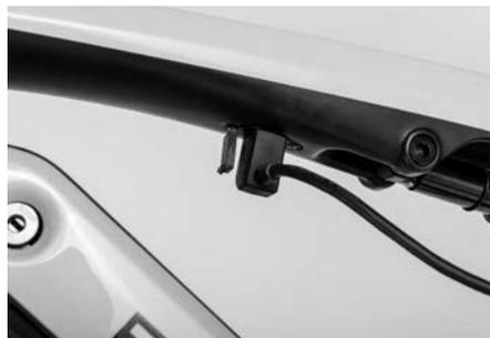
Der Ladevorgang startet automatisch. Eine blinkende Ladezustandsanzeige weist daraufhin, dass der Ladevorgang im Gange ist. Das Ladegerät zeigt einen andauernden Ladevorgang durch eine leuchtende LED-Lampe an.
