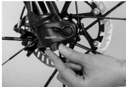
Zu geringe Dämpfung führt zu einem sehr schnellen Ausfedervorgang der Gabel. Zu straffe Dämpfung bewirkt, dass die Federgabel bei schnell aufeinanderfolgenden Stößen zusammensinkt, da sie nicht mehr schnell genug ausfedern kann.
