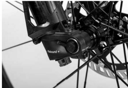
Das Vorderrad des PORSCHE eBike Cross besitzt eine werkzeuglose Achsverschraubung. Klappen Sie den Schnellspanner an der Schraubachse auf und schieben Sie die leicht gefettete Achse durch die Nabe bis das Gewinde im Ausfallende gegenüber greift. Drehen Sie die Achse fest und bringen Sie die Vorspannung auf, indem Sie den Spannhebel um 90° nach oben umlegen.
