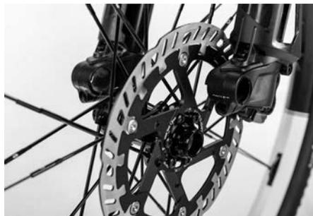
Bei den Vorderrädern der PORSCHE eBikes kommen Schraubachsen zum Einsatz. Achten Sie beim Einsetzen der Vorderradnabe darauf, dass die Nabe fest in den Ausfallenden sitzt und die Bremsscheibe korrekt im Bremssattel zentriert ist.
