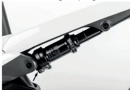
Zur richtigen Einstellung wird das rote Einstellrad im ersten Schritt bis zum Anschlag gegen den Uhrzeigersinn gedreht. Anschließend wird in kleinen Schritten / Klicks im Uhrzeigersinn die Einstellschraube gedreht bis die richtige Stoßdämpfereinstellung eingestellt ist.
