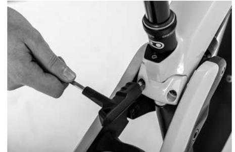
Abb. 42: Keilverschraubung / Dropper-Sattelstütze
