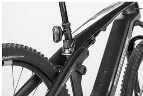
Beide Lichter werden mit den passenden Schrauben geliefert. Diese werden mit 4 Nm festgeschraubt.
