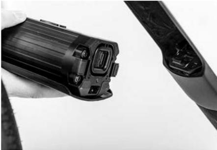
Sichern Sie abschließend die Antriebsbatterie im Unterrohr. Stecken Sie hierzu den Schlüssel in den Schließzylinder der Antriebsbatteriehalterung am oberen Ende
