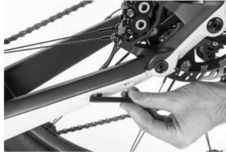
Um den Ständer nun zu montieren, halten Sie den Ständer auf der Innenseite der Kettenstrebe in die dafür vorgesehene Aussparung.
