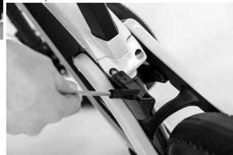
Abb. 11: Keilverschraubung Sattelstütze prüfen
